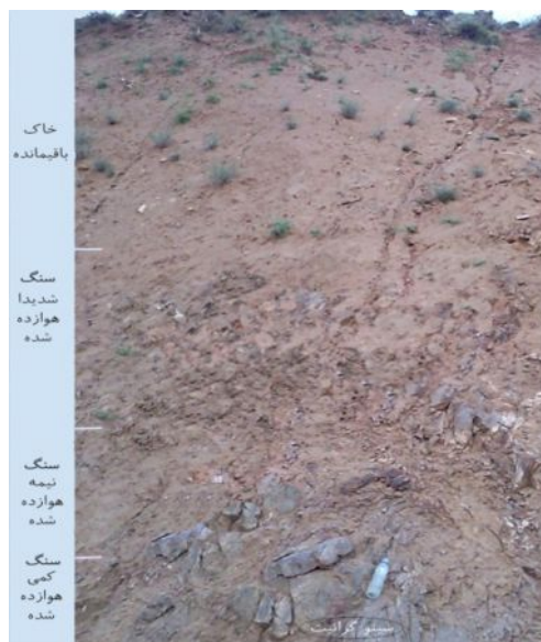
شکل ۲- مراحل هوازدگی توده سنگ (سینوگرانیت) و تشکیل خاک باقی مانده در بخشی از مسیر مورد مطالعه
