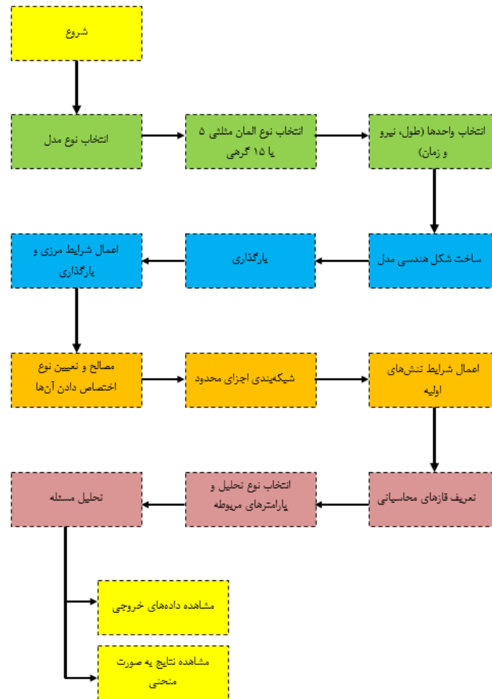
شکل ۲. فلوچارت مراحل ساخت و اجرای مدل توسط نرم‌افزار PLAXIS
