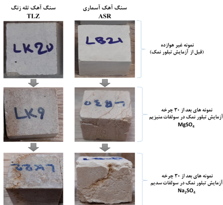
شکل ۱۰. مقایسه تاثیر سولفات سدیم و منیزیم بر روی سنگ‌آهک‌های مورد مطالعه
