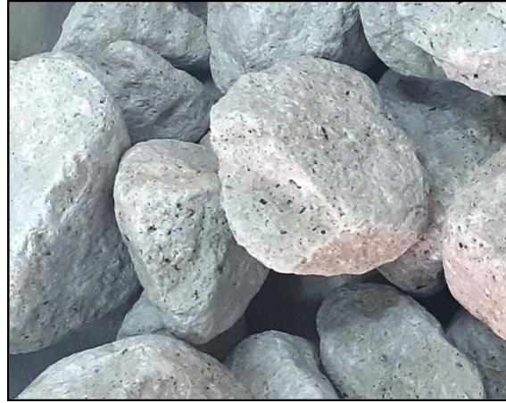
شکل ۱۱. نمونه شستشو داده شده S7 بعد از آزمایش لس آنجلس که در آن حفرات سطحی نمایانگر جدا شدن کانی‌های سست مانند کانی‌های مافیک هستند.
