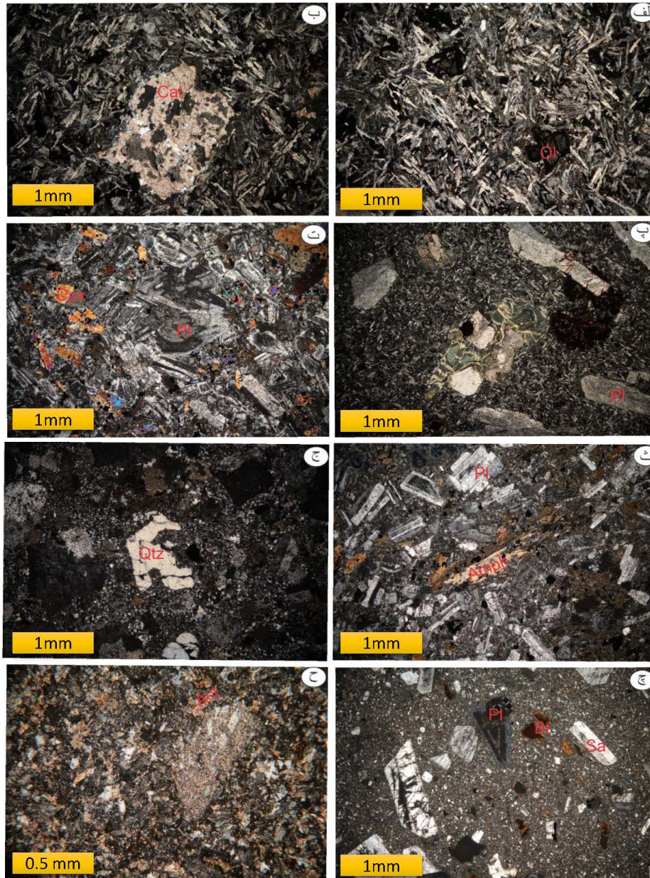
شکل ۳. تصاویر میکروسکوپی نمونه‌های مورد مطالعه (الف) پلاژیوکلاز و بقایای اولیوین (ب) بادامک پر شده با کلسیت در بازالت بادامکی، (پ) درشت بلور پلاژیوکلاز و کلریت جانشین شده در کانی مافیک بازالت با بافت پورفیری، (ت) بافت پورفیری و کانی‌های پلاژیوکلاز و کلینوپیروکسن در آندزیت بازالتی، (ث) بافت سری‌ایت در آندزیت، (ج) کوارتز با خوردگی خلیجی در داسیت با بافت پورفیری فلسیتی، (چ) پلاژیوکلاز، سانیدین، کوارتز و آمفیبول در ریولیت با بافت هیالوپورفیری، (ح) پلاژیوکلاز تجزیه شده در زمینه ریزدانه فلدسپار و اکتینولیت در توف ریولیتی. Qtz: کوارتز، Bt: بیوتیت، Pl: پلاژیوکلاز Sa: سانیدین، Cpx: کلینوپیروکسن، Amph: آمفیبول، Act: اکتینولیت، Ol: اولیوین، Cal: کلسیت.
