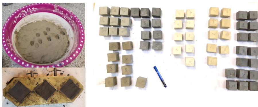
شکل ۳. مراحل مختلف آماده‌سازی، قالب‌گیری و تهیه خشت خام از نمونه‌های مورد مطالعه
