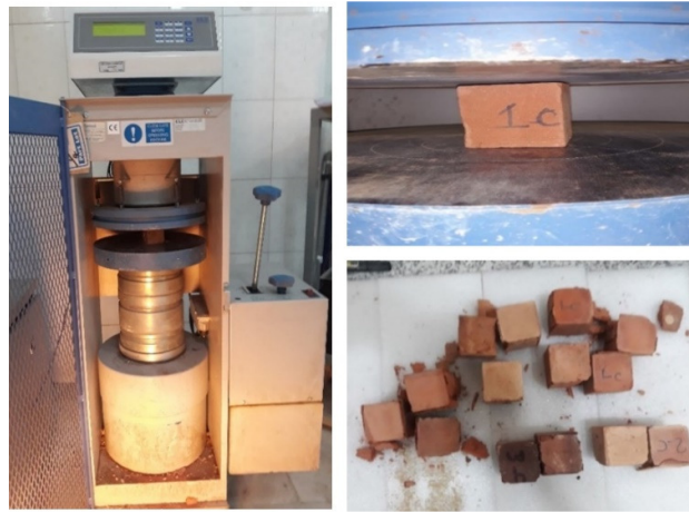
شکل ۵. تصاویر انجام آزمون مقاومت فشاری نمونه‌های آجر ساخته شده Fig. 5. Pictures of the compressive strength test of the brick samples
