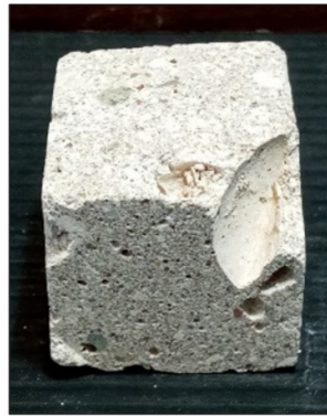
گسترش ترک در مرز بین قطعات و خمیره ملاط
