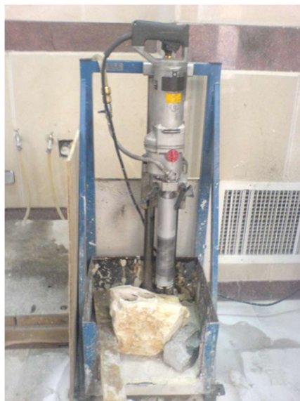
شکل ۱. مغزه‌گیری و آماده‌سازی نمونه‌ها
