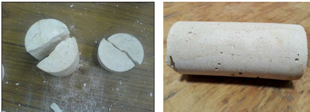
شکل ۳. شکست نمونه مغزه با قطر ۵۴/۸۸ و طول ۱۵۰ میلی‌متر حین بارگذاری تنش فشاری Fig. 3. Rock failure modes under uniaxial compression (d=54.88 mm, h=150 mm)
