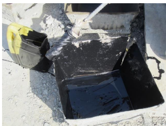
شکل ۶. آماده‌سازی پنل‌ها جهت تهیه نمونه‌ها
