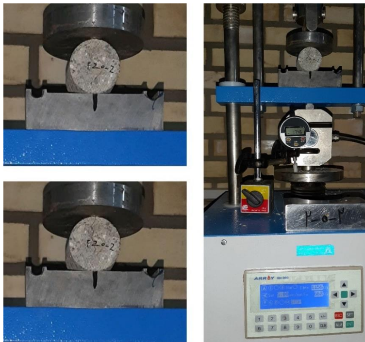
شکل ۱۰. نحوه انجام آزمایش برزیلی بر روی نمونه‌های شاکریت الیافی
