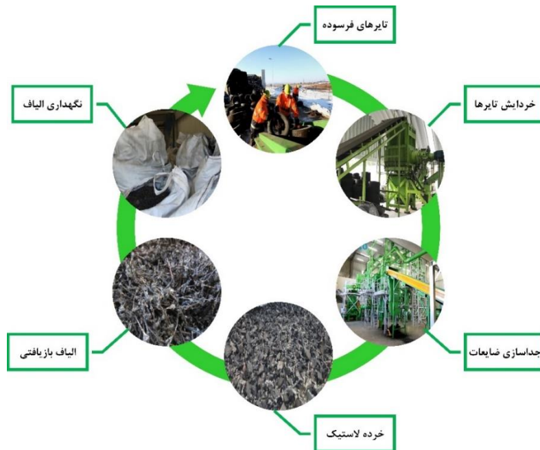
شکل ۴. فرآیند تولید و جداسازی ضایعات حاصل از تایرهای فرسوده
