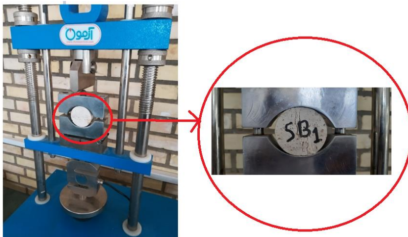
شکل ۹. انجام آزمایش مقاومت کششی برزبلی بر روی نمونه‌های دیسکی
