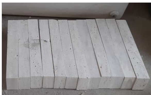
شکل ۳. نمونه‌های مکعب مستطیل تهیه شده جهت انجام آزمایش‌های خمش
