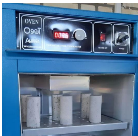
شکل ۵. عملیات تعیین خواص فیزیکی نمونه‌های تراورتن
