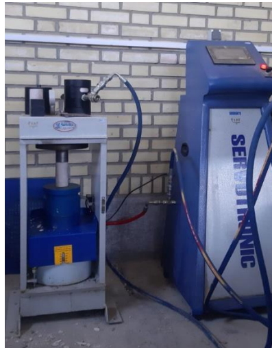
شکل ۸. انجام آزمایش مقاومت فشاری تک محوری بر روی مغزه‌ها
