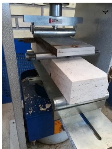
شکل ۶. الف- روش آزمایش خمش سنگ ساختمانی (ISIRI-8229) و ب- قرارگیری نمونه در دستگاه آزمایش خمش ۴ نقطه
