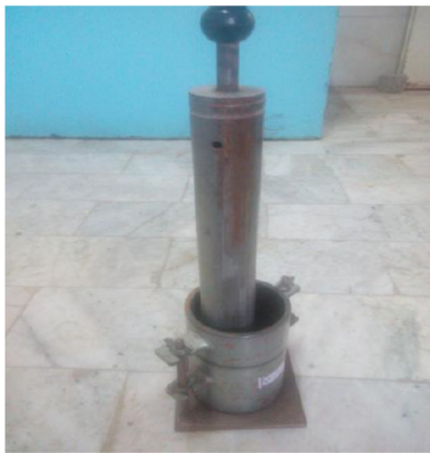
شکل ۴. دستگاه آزمایش تراکم مورد استفاده در پژوهش حاضر
