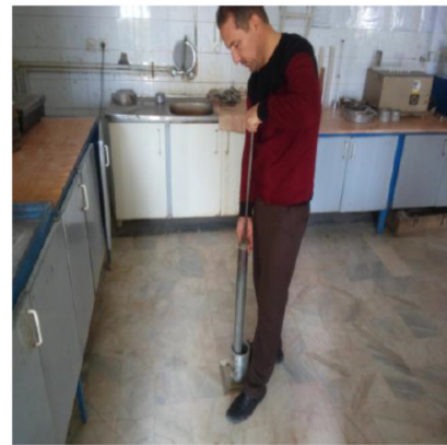
شکل ۴. دستگاه آزمایش تراکم مورد استفاده در پژوهش حاضر
