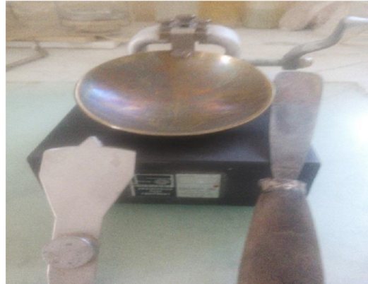
شکل ۳. دستگاه کاساگرانده برای تعیین حد روانی خاک مورد مطالعه
