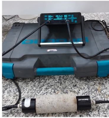
شکل ۲. تعیین سرعت امواج فراصوتی نمونه‌ها
