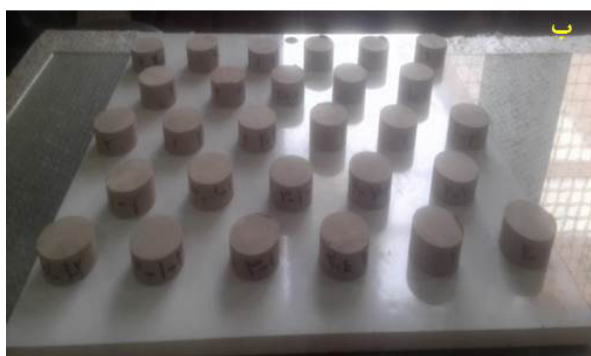
شکل ۳. الف) مغزه‌های گرفته شده از ماسه‌سنگ و ب) نمونه‌های دیسکی شکل آزمایش برزلی
