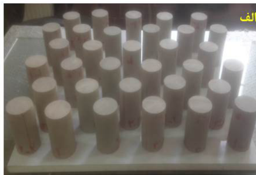
شکل ۳. الف) مغزه‌های گرفته شده از ماسه‌سنگ و ب) نمونه‌های دیسکی شکل آزمایش برزلی
