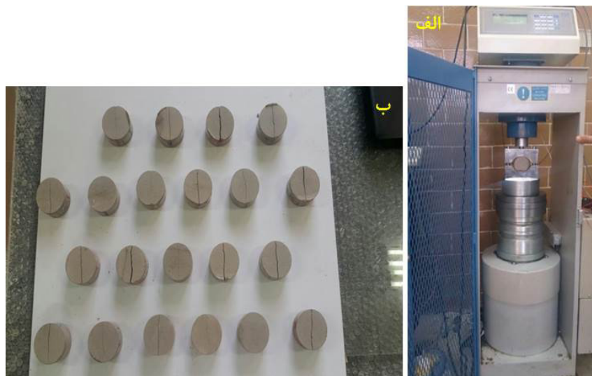
شکل ۴. الف) آزمایش برزیلی انجام شده روی یکی از نمونه‌ها و ب) تعدادی از نمونه‌ها بعد از انجام آزمایش برزیلی
