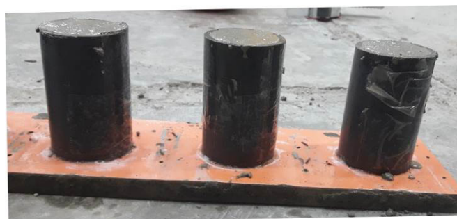
شکل ۱. قالب‌های پر شده از بتن
