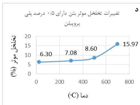
شکل ۳. الف) تغییرات تخلخل موثر در بتن بدون الیاف بر اثر دما، ب، ج و د). تغییرات تخلخل موثر در بتن الیافی پلی‌پروپیلن بر اثر دما
