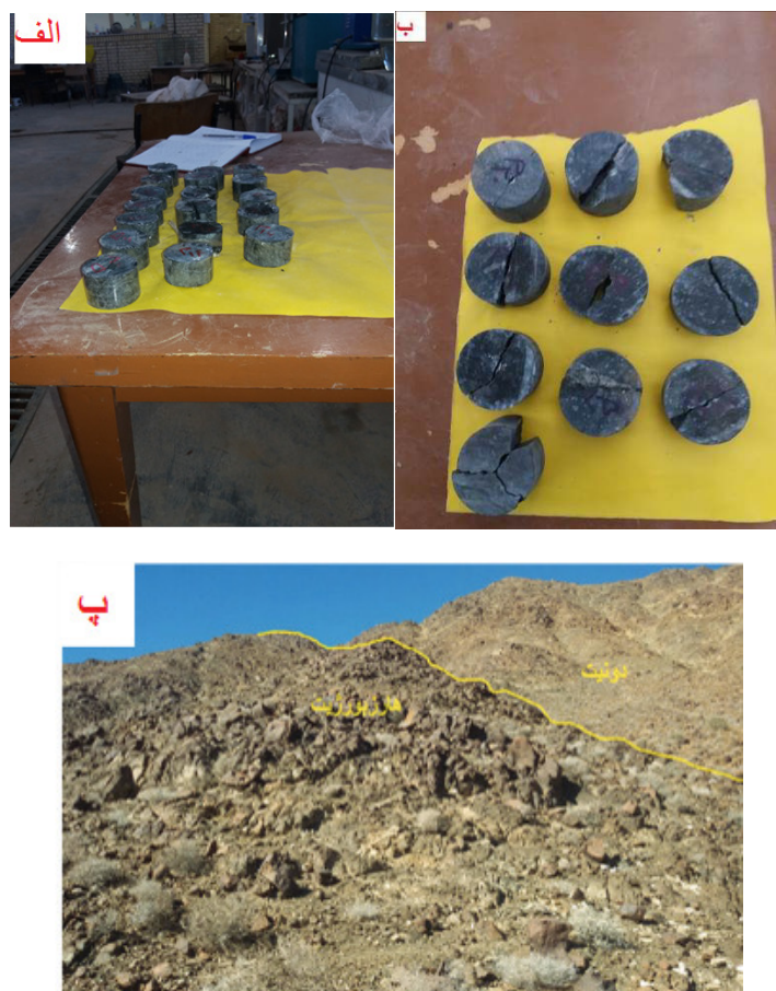
شکل ۴. الف) نمونه‌های پریدوتیت قبل از آزمایش برزیلین (ب) نمونه‌های پریدوتیت بعد از آزمایش برزیلین (پ) نمونه صحرایی پریدوتیت
