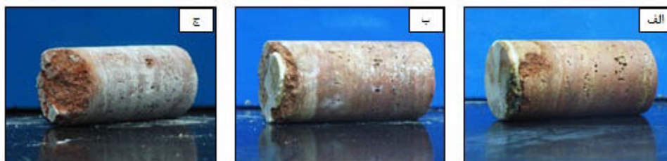
شکل ۵. تخریب شیمیایی گوشه نمونه تراورتن قرمز در آزمایش هوازدگی نمک (الف) چرخه ۴۰ (ب) چرخه ۵۰ (ج) چرخه ۶۰
