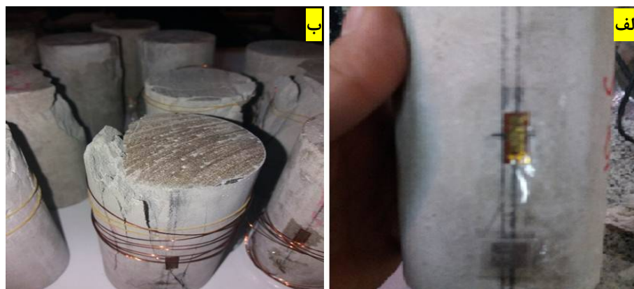
شکل 7. نمونه‌های استوانه‌ای به کار رفته برای تعیین مدول الاستیسیته (الف) کرنش سنج نصب شده بر روی نمونه (ب) نمونه‌های شکسته شده پس از آزمایش
