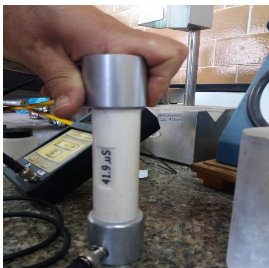
شکل 3. کالیبره کردن دستگاه آزمایش تعیین سرعت اموج طولی
