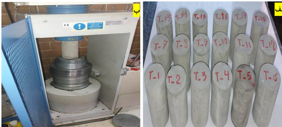
شکل 5. آزمایش بارگذاری تک‌محوره (الف) تعدادی از نمونه‌های آماده شده (ب) نمونه تحت بارگذاری
