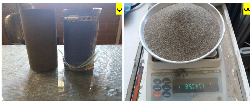
شکل 1. آماده‌سازی نمونه‌های ملات سیمان، الف) استفاده از ترازوی دیجیتال برای وزن کردن مصالح، ب) نمونه ملات سیمان ساخته شده
