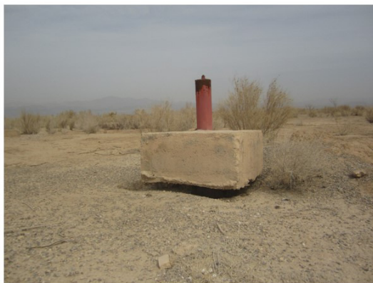
شکل ۱۲. تصاویری از بیرون‌زدگی لوله جدار پیژومترها در شرق اعلا
