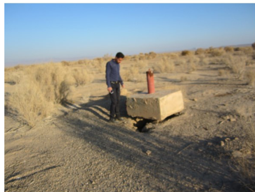
شکل ۱۲. تصاویری از بیرون‌زدگی لوله جدار پیژومترها در شرق اعلا
