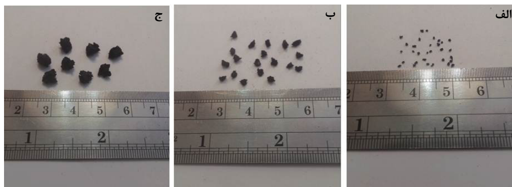
شکل ۲. تصویر ذرات گرانول لاستیک بازیافتی مورد مطالعه: الف- ۱ میلی‌متر، ب- ۳ میلی‌متر، ج- ۵ میلی‌متر
