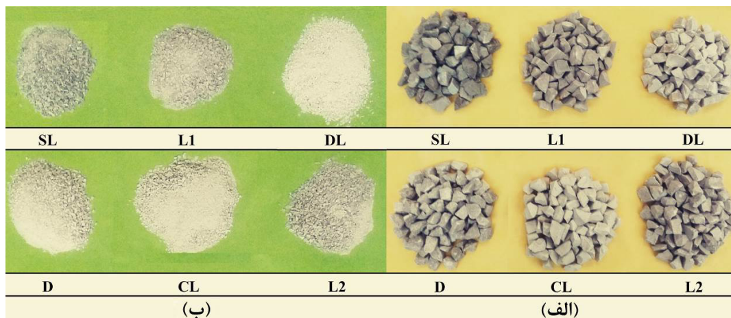
شکل ۵. نمونه‌های آزمایش ارزش ضربه‌ای؛ الف) سنگدانه‌ها قبل از انجام آزمایش ب) مصالح خرد شده عبوری از الک شماره ۸ پس از آزمایش
