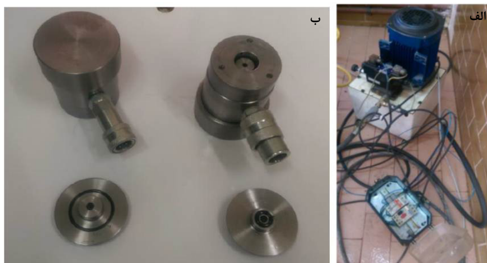
شکل ۶. الف) پمپ اعمال کننده فشار داخلی گمانه، ب) کفپوش‌ها و صفحات بارگذاری طراحی شده
