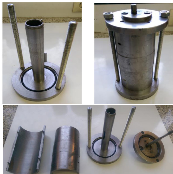
شکل ۲. نمای بیرونی و درونی قالب و محل تعبیه شده برای ایجاد ترک مصنوعی
