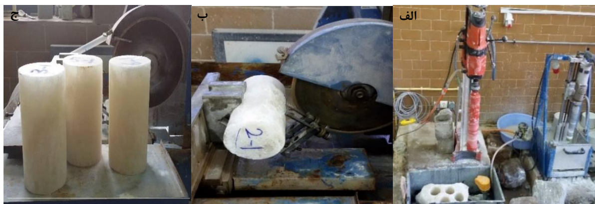
شکل ۱. (الف) دستگاه مغزه‌گیر و سیستم بازیابی، (ب) برش و تسطیح نمونه‌ها، (ج) نمونه‌های آماده شده نمک
