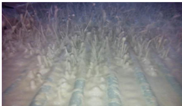
شکل ۴. جداسازی جامدات و کنده‌های حفاری از سیال بر روی توری لرزاننده
