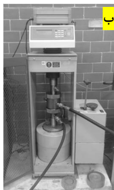
شکل ۶. الف) پمپ اعمال کننده‌ی فشار سیال به داخل گمانه، ب) دستگاه آزمایش در هنگام یکی از آزمایش‌های شکست هیدرولیکی
