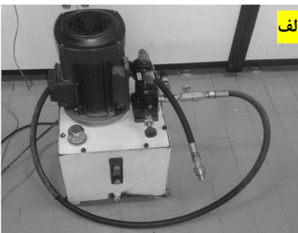
شکل ۶. الف) پمپ اعمال کننده‌ی فشار سیال به داخل گمانه، ب) دستگاه آزمایش در هنگام یکی از آزمایش‌های شکست هیدرولیکی
