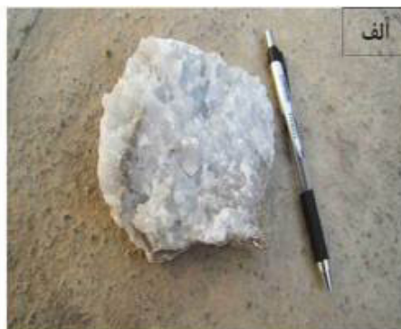
شکل ۸. الف) ساخت دانه‌شکری در نمونه دستی سلسیت کانسار بابامحمد، ب) رشد بلورهای درشت سلسیت بر روی بلورهای با اندازه کوچک‌تر (ریت‌های تبلور دیاژنتیکی) در زمینه‌ای از آهک میکرایتی میزبان
