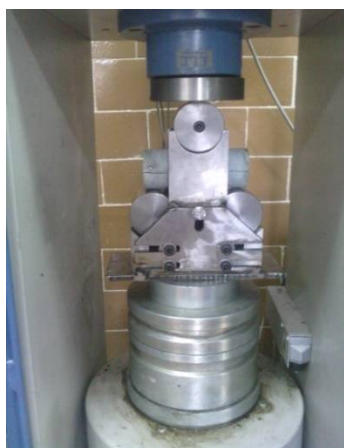
شکل 4. دستگاه مخصوص آزمایش خمش سه نقطه‌ای که در زیر دستگاه اعمال بار محوری قرار گرفته
