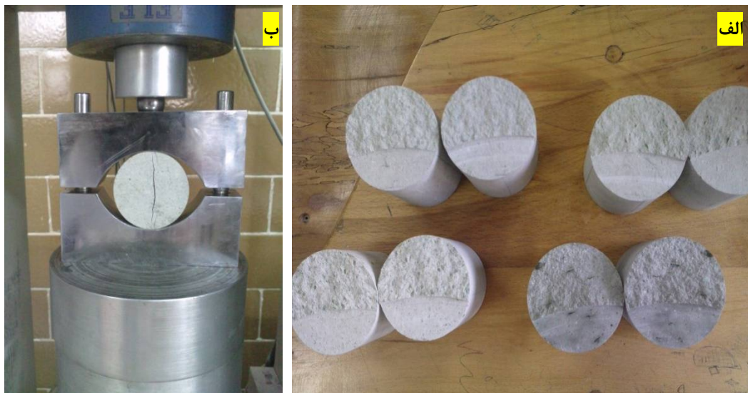
شکل 5. الف) نمونه‌ها شکست شده پس از انجام آزمایش خمش سه نقطه‌ای، ب) شکست قطری نمونه در آزمایش برزلی
