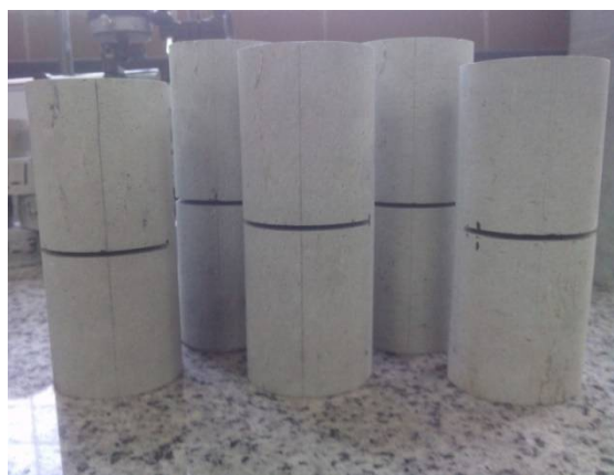
شکل 2. نمونه‌های آماده شده برای آزمایش خمش سه نقطه‌ای
